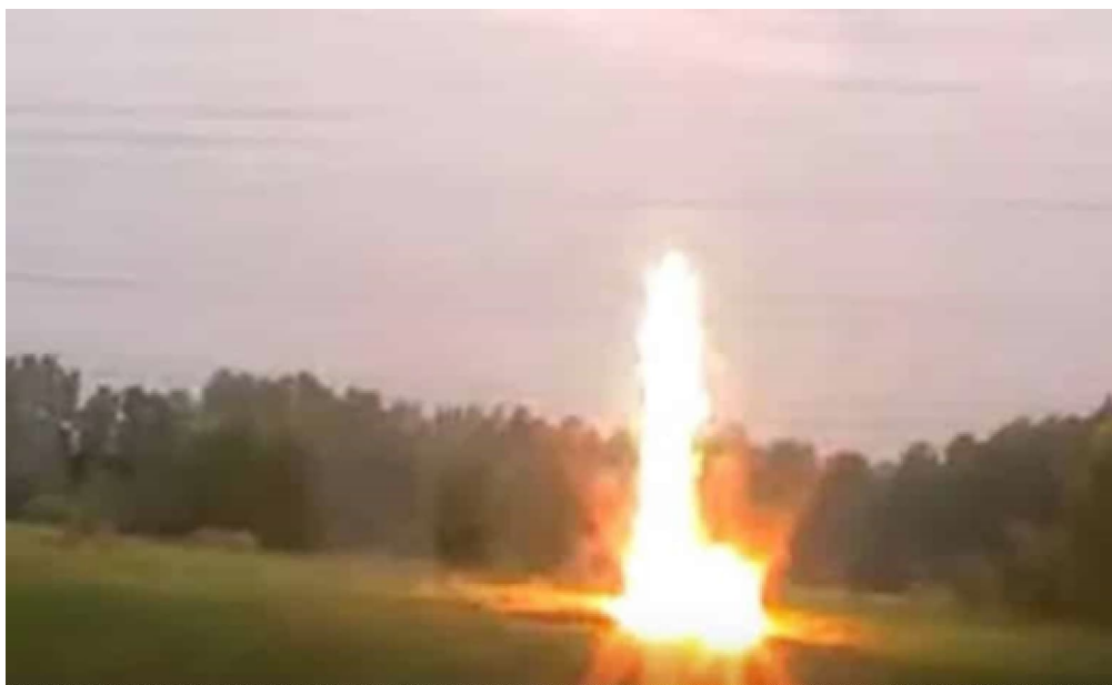
Рис.2: Пробой ВЛ на землю (электрическая дуга) в месте разведения костра.
